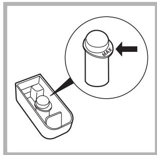
Funkcja ta przydatna jest w celu usuwania bardziej opornych plam. Wstawić dodatkowy pojemniczek 4, na wyposażeniu, do przegródki 1. Przy dozowaniu wybielacza nie przekroczyć poziomu „max” wskazanego na środkowej ośce (patrz rysunek).
